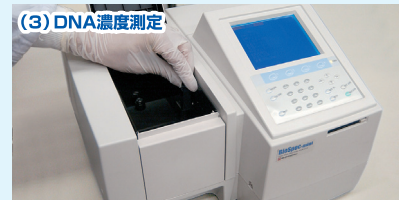
(3) DNA濃度測定 抽出されたDNA溶液の収量を測定し、濃度を調整します。
