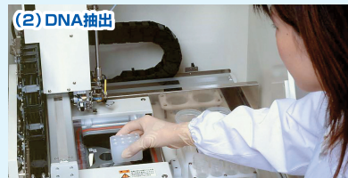
(2) DNA抽出 DNA抽出装置に前処理した液と試薬をセットし、DNA溶液を抽出します。
