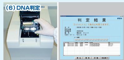
(6) DNA判定 充填した米品種判定用チップをDNA判定装置にセットし判定を開始すると、約5分で結果が表示されます。
