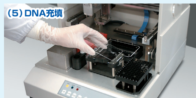
(5) DNA充填 増幅させたDNAと試薬を、分注口ポットで米品種判定用チップに充填します。
