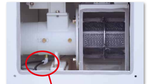
圧縮空気を送り込むエア配管
