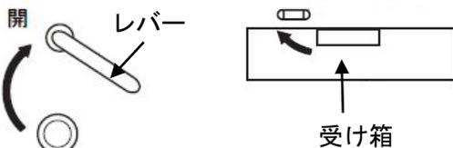
残米排出レバーを引いて回し、下の受け箱から残米を掃除してください。
