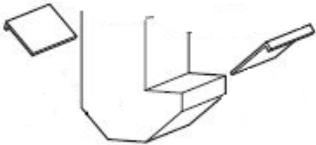
混合米昇降機および精品昇降機のシャッターを外し、残米を掃除してください。
