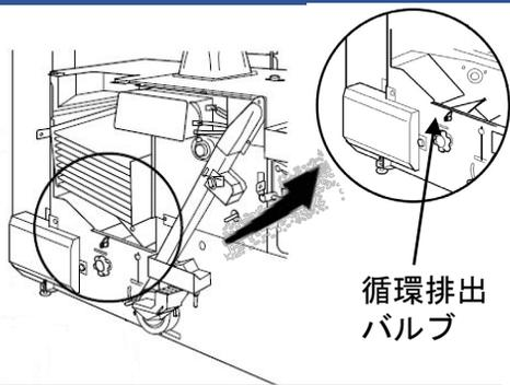
フロントカバーを取外し、選別板や循環排出バルブの周りを掃除します。
