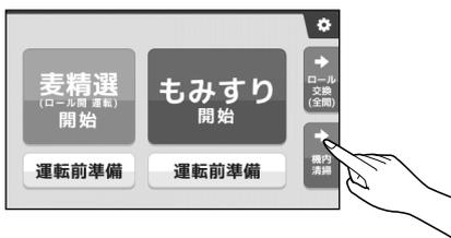
2) タッチパネルの **機内清掃** ボタンを押します。
