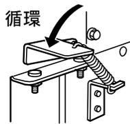
(a) 精品に麦が混入しそうであれば、[メインレバー]を[①]にして、[循環]に切り換えます。
