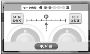
(b) ロールすきまを調整する場合は、タッチパネルの「ロール開閉」ボタンを押します。
