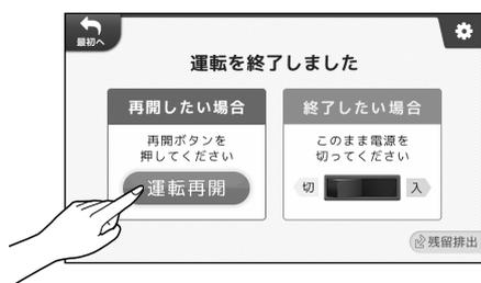
1) タッチパネルの「運転再開」ボタンを長押しします。
