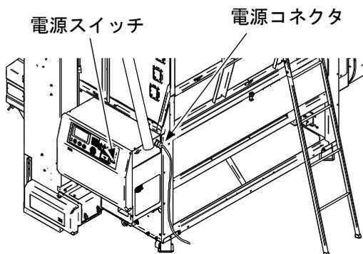
各部の掃除・点検をする場合は、電源スイッチを切り、電源コネクタを抜いて行ってください。電源コネクタを抜かないと、点検中、感電するおそれがあります。
