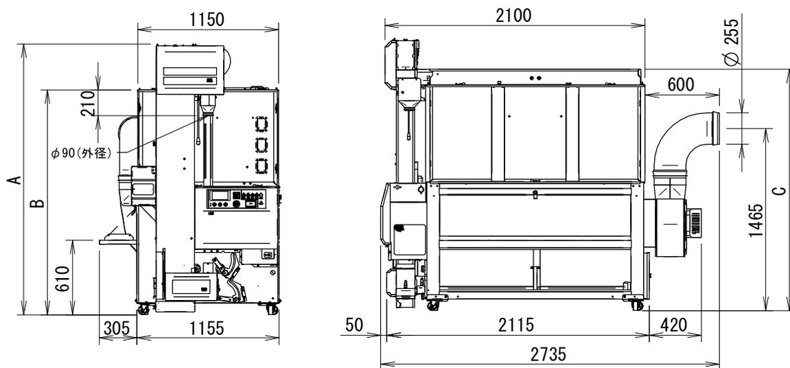
図 7 SDR900・1100RSW 機体寸法
