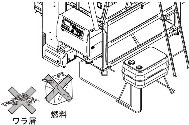
バーナ周辺 2m以内にワラ屑、燃料などの可燃物を置かないでください。燃料タンクは機械の側面から 1m以上離して置いてください。火災の原因になります。
