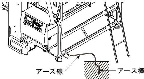
漏電による感電や火災防止、機械の誤動作防止のため、必ず接地（アース）をしてください。接地（アース）工事は、お買い上げの販売店または電気工事店にご相談ください。
