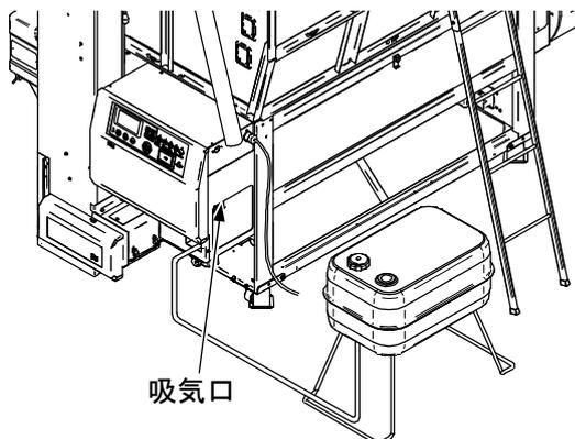
乾燥運転前に、熱風胴・バーナボックス内、バーナの掃除をしてください。
