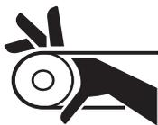
カバー類はすべて取り付けて運転してください。カバーを取り付けないと、駆動部でけがをするおそれがあります。
