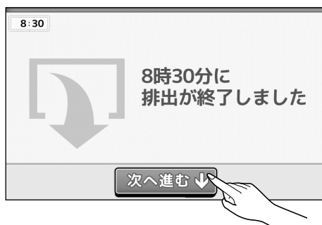
[排出運転自動停止 画面]
