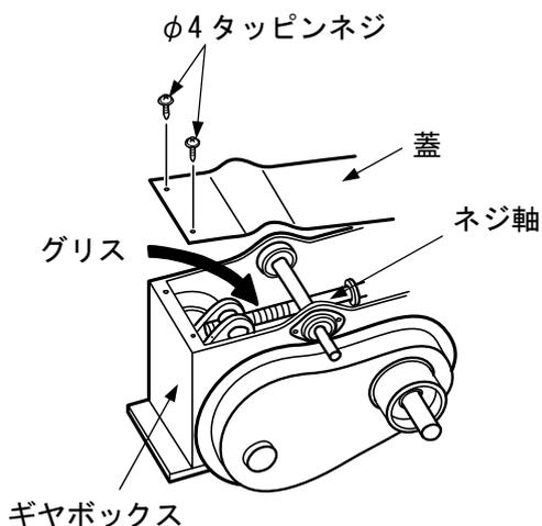
9) 粉摺部ギヤボックス内部を掃除します。
