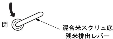
4) [混合米スクリュ底残米排出レバー]を閉めます。
