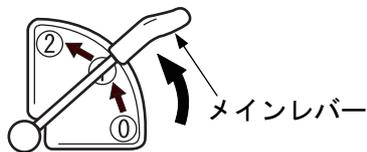
(b) ロールすきま調整が終了し、ロールすきまランプが点滅から点灯に変わり、ロールすきまが0.8mmに設定されます。
