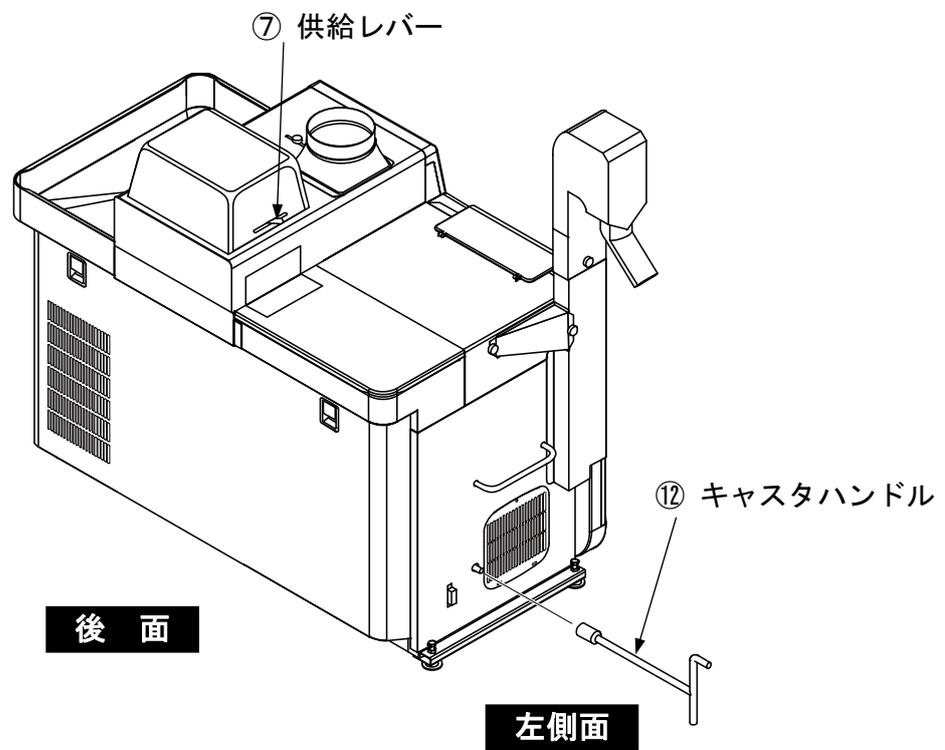
図 7 機械操作箇所 (2)
