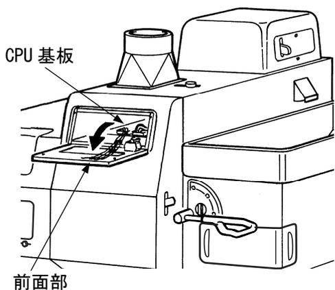
3) コントロールボックスの前面部を前側に倒します。
