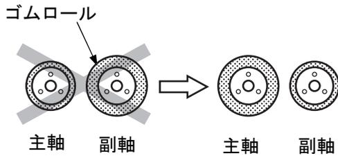
(c) 主軸ゴムロールが、副軸ゴムロールに比べて極端に摩耗していないか確認します。
