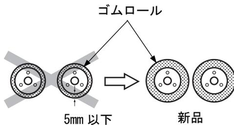
(d) ゴムロールが極度に摩耗・偏摩耗をしていないか確認します。
