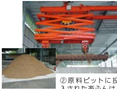
②原料ピットに投入された畜ふんは、懸垂型クレーンによって堆肥化発酵の開始に適した水分の70%前後に調整するため、おが粉を混合させる。
