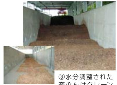
③水分調整された畜ふんはクレーンにて区分けされた堆積エリアの醗酵部に堆積され、送気口から送気しながら醗酵させる。
