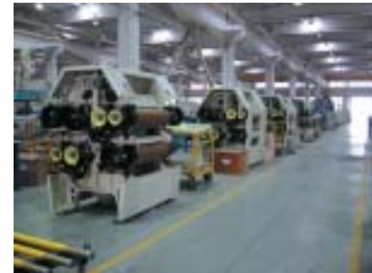
製粉機の組立工程
