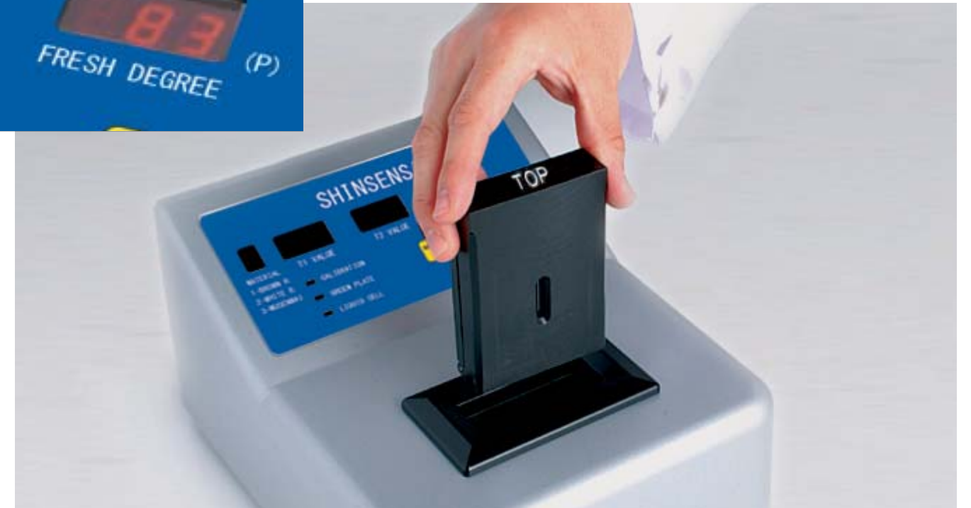
特殊な試薬をサンプルのお米に混ぜ合わせて、攪拌工程を行ったのち、その試薬の色の変化をフォトセンサで光学的に測定します。
