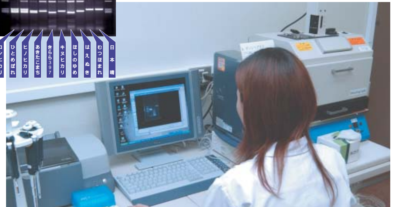
分析装置で、増幅させたDNAに電気を流し、その反応をパターン化します。
