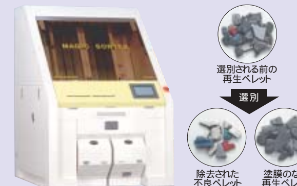
不良ペレットを取り除くための技術開発のベースとなった色彩選別機マジックソーター
