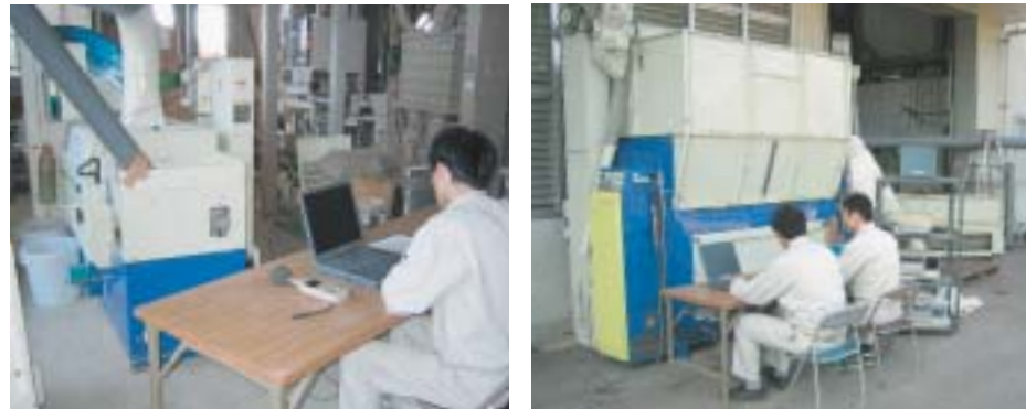
石垣島八重山ライスセンターでの試験の様子。左が籾摺機「ネオライスマスター」、右が乾燥機「マジックドライヤー」。
