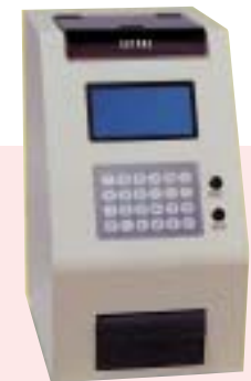
写真3 CTA-10A 開発当初に比べ、格段にコンパクト化され、粒のままの測定が実現した。
