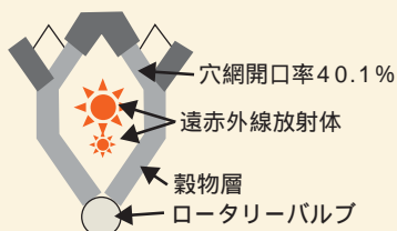
図3 マジックドライヤーと遠赤外線乾燥機(当社試作機)の比較
